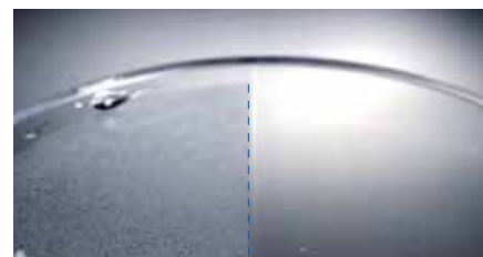
Páramentes (anti-fog) bevonat 8 másodperc után. | uvex supravision ETC
