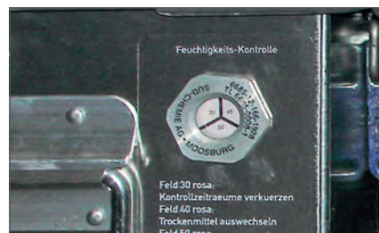
Automatikus nyomáskiegyenlítő szelep és nedvességkijelző az alapfelszerelésben.
