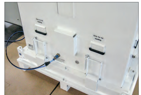
Vízgőzálló tartály túlnyomással végzett tömítésvizsgálattal
